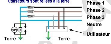
Pour un défaut significatif, le système de protection coupe l'alimentation des schémas TT et TN. Pour le schéma IT, l'alimentation n'est pas coupée au premier défaut (pas de risques pour les utilisateurs), une alarme visuelle et sonore prévient qu'il y a un défaut. Le système de protection coupe l'alimentation au second défaut (court-circuit).
