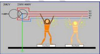
Contact entre une partie active sous tension et une autre partie active sous tension.
