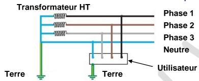
Ce type de schéma est techniquement simple à concevoir, à mettre en œuvre. L'alimentation est coupée dès le premier défaut détecté (ce qui est un avantage, mais peut se révéler comme une contrainte en milieu industriel). C'est un schéma utilisé dans nos habitations en France avec la mise en place de protections différentielles 30 mA.
