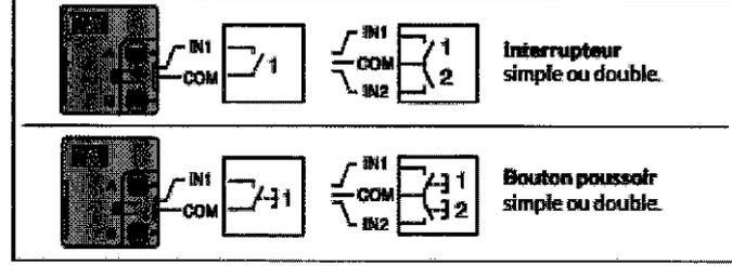
Possibilité de rallonger jusqu'à 10m les fils de la commande locale (à séparer du 230V).
