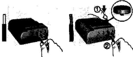
A l'aide de l'outil fourni ou d'un tournevis de 2,5 mm, appuyez sur le bouton de la borne puis insérez le fil.
